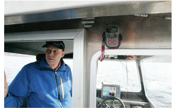
Autopilotin kaukosäätö on ulkona avotilan seinässä. Isoa plotteria pystyy lukemaan myös ulkoa.
