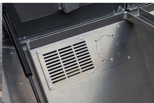
Färdiga bussningar för kablar i fören.
