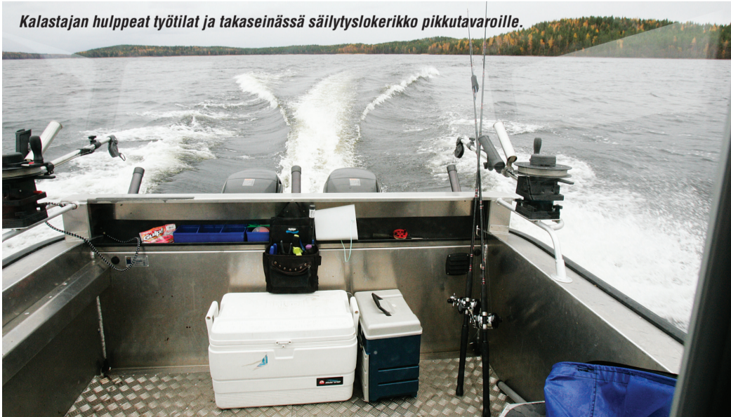
Alutroll Pilotfish painaa noin 850 kg eikä kallistele miehistön siirtymisessä puolelta toiselle. Pohjan kulma on 18 astetta.
